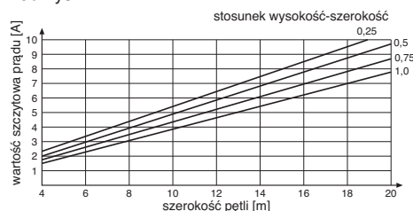
Rys. 7 Wartość szczytowa prądu w pętli indukcyjnej
