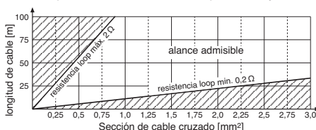
Esquema 5 Sección de cable cruzado requerida para el loop de inducción
