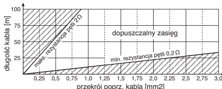
Rys. 5 Przekrój poprzeczny kabla odpowiedni dla pętli
