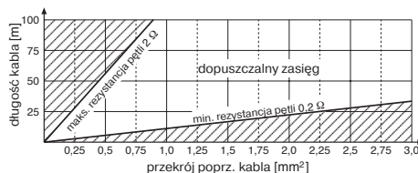
Rys. 5 Przekrój poprzeczny kabla odpowiedni dla pętli
